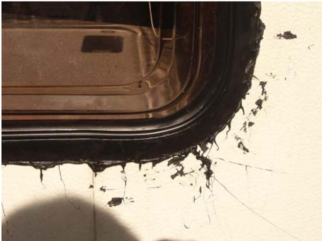
**Hinterspritzen der Dichtung mit ausreichend viel Butylmasse ☺ und Einziehen vom Fensterkeder.**
