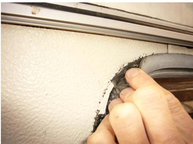
**..der Dichtung vom Alublech wird auch dieses Fenster durch vorsichtiges Ziehen und innenseitigem Drücken aus dem Rahmen gezogen.**
