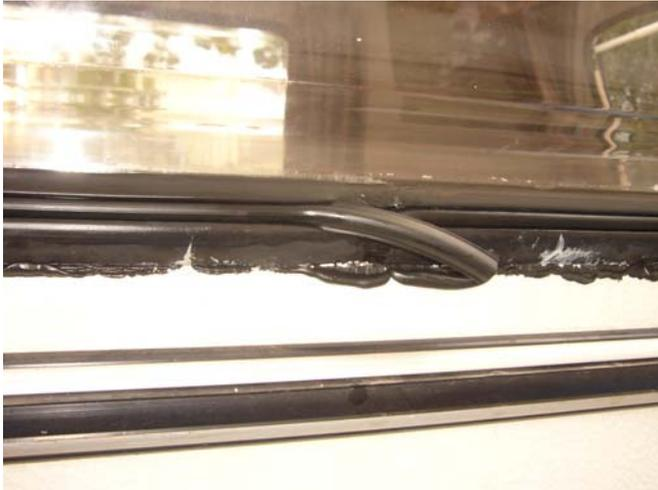
**Im Bereich der Stoßfläche den Keder länger belassend abschneiden.**
