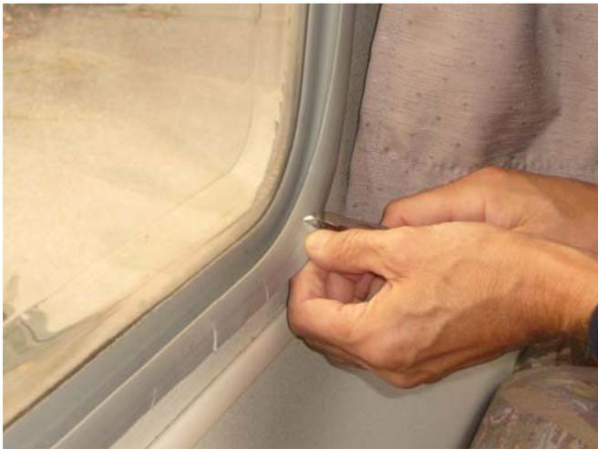
**Zum besseren Entfernen der alten, starren Dichtung wird diese innenseitig alle 10 cm eingeschnitten.**
