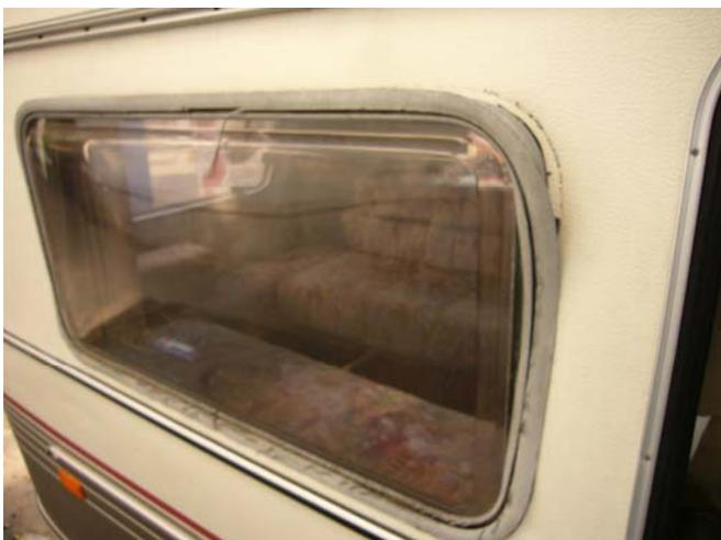
**Nach zirkulärem Ablösen der Dichtung vom Alublech wird das Fenster durch vorsichtiges Ziehen und innenseitigem Drücken aus dem Rahmen gezogen....**
