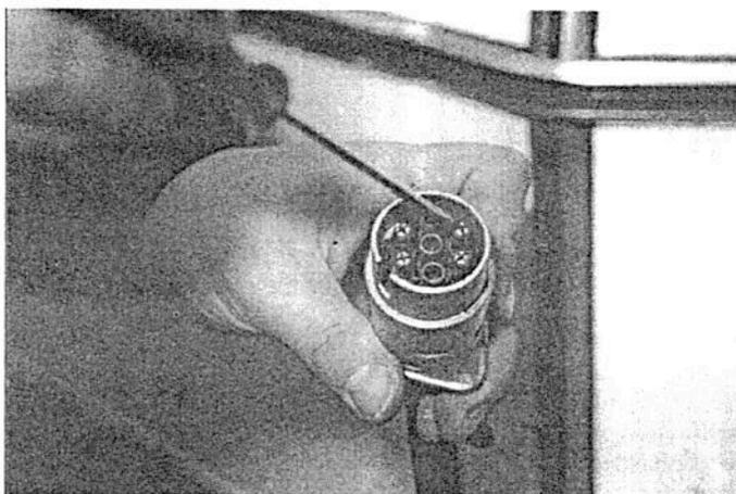
Häufige Fehlerquelle: Zusammengequetschte Stifte in der Steckverbindung, die mit dem Schraubenzieher einfach wieder auseinandergebo-gen werden.
