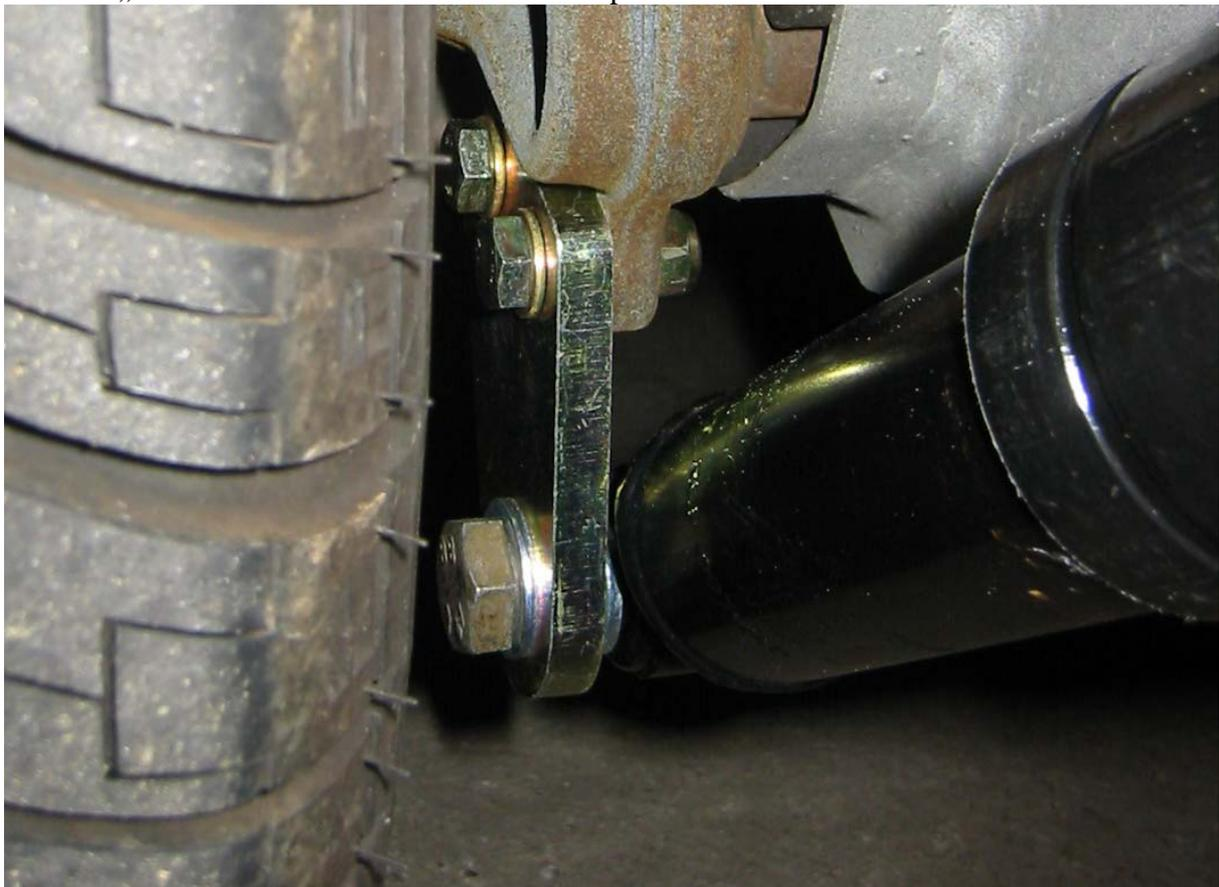
Die Verschraubung des Dämpfers am Rahmen
