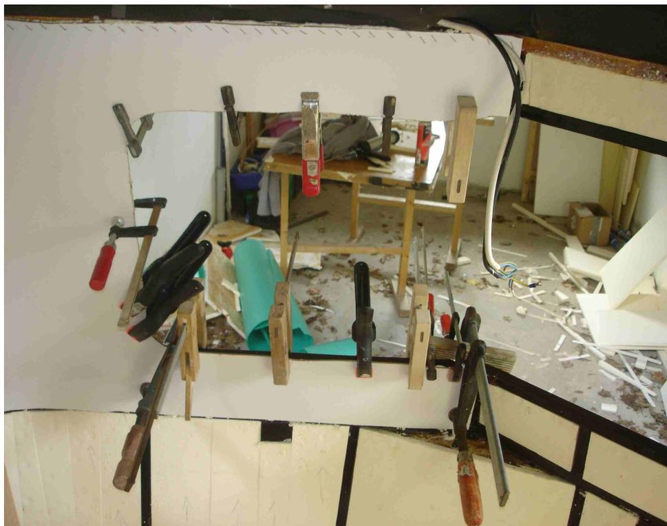
Jetzt erstmal die zugeschnittenen Stücke probeweise in die Rundung drücken und sich **vorher** jede Menge Schraub/Klemmzwingen und Balken zum andrücken zurechtlegen, da der Kleber schon nach 10 Minuten angezogen hatte und wenn man sich dann erst die Balken sucht...!
