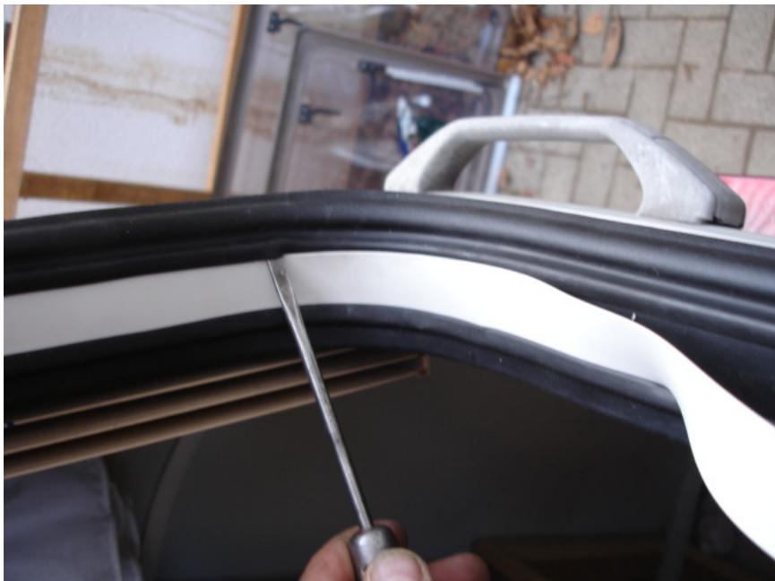
Nun müssen die Fenster wieder eingebaut werden. Dazu diese von außen in die Scharnierleiste setzen, mittig ausrichten und mit Hilfe einer zweiten Person mit „mäßiger Kraft“ zudrücken, sodaß die Dichtung rundherum anliegt.
